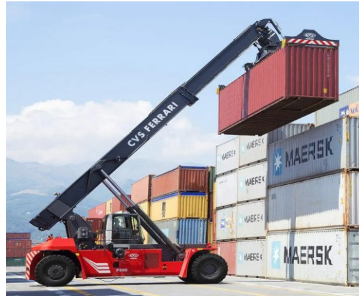
FIGURA 4 - EQUIPAMENTO REACH STACKER PONDO UM CONTÊINER SOBRE UMA PILHA
