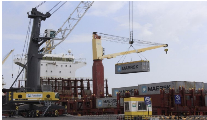
FIGURA 1 - GUINDASTE MÓVEL SOBRE PNEUS EM OPERAÇÃO DE NAVIO DE CONTÊINERES NO PORTO DO ITAQUI
