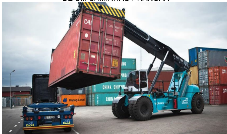
FIGURA 3 - EQUIPAMENTO REACH STACKER PONDO UM CONTÊINER SOBRE A CARROCERIA DE UM CAMINHÃO PRANCHA
