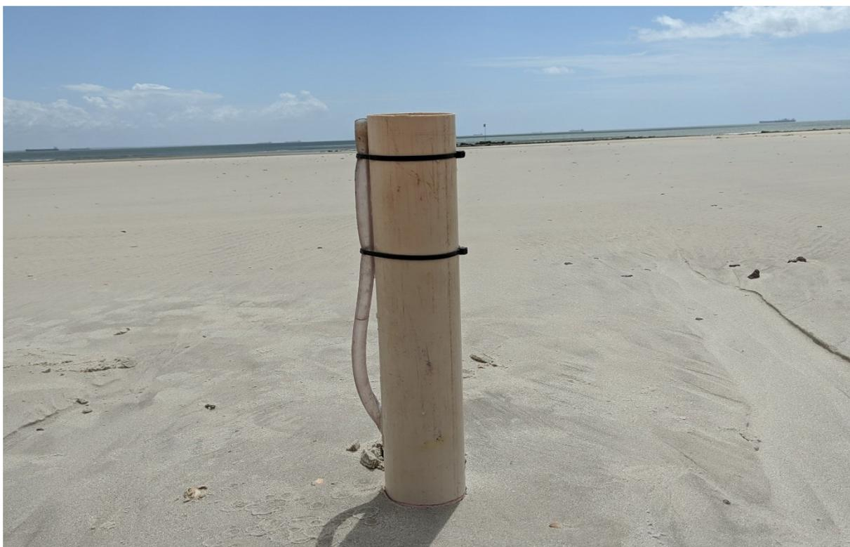
**Figura 6.** Ensaio geotécnico de permeabilidade realizado na face praial.
