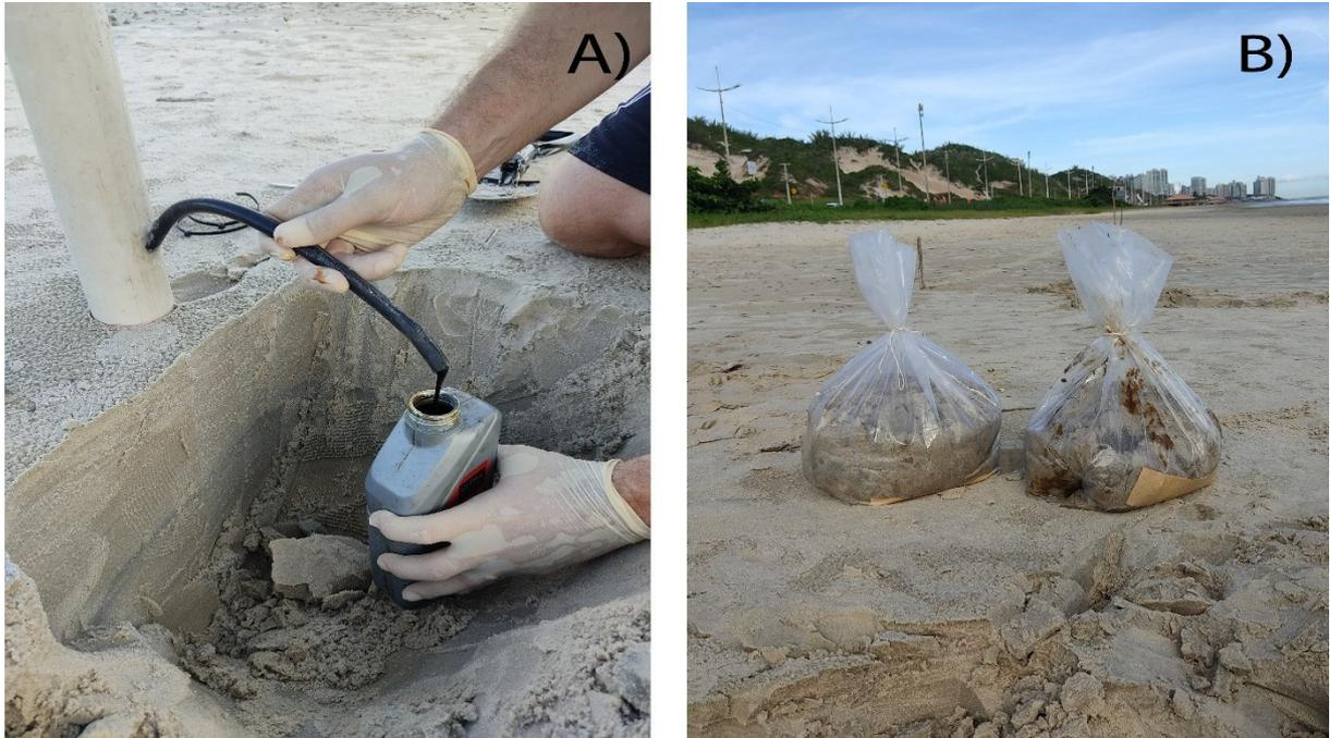
**Figura 9.** Remoção do óleo na sedimentação da praia, onde A foi a remoção feita pelo nível de inspeção do permeâmetro e B foi o sedimento contaminado em sacos plásticos.
