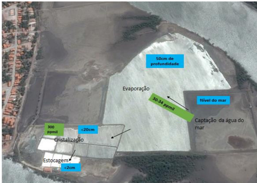
Figura 3. Processo de absorção, deposição e formação de sais em salina no município de Primeira Cruz.
