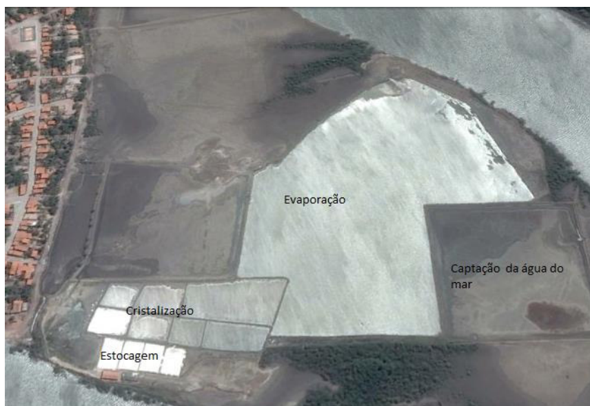
Figura 2. Etapas necessárias para a cristalização do cloreto de sódio.
