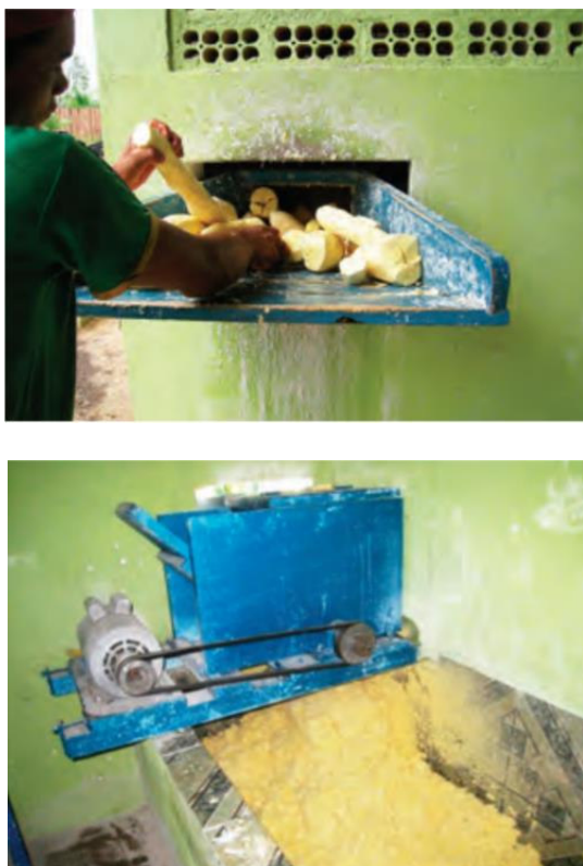
Figura 13 - Processo de ralação mecânica da mandioca em tanque de alvenaria
