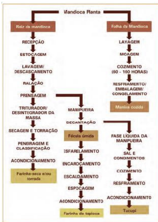
Figura 7 - Fluxograma da produção de farinha-seca, farinha de tapioca, fécula, maniva e tucupi
