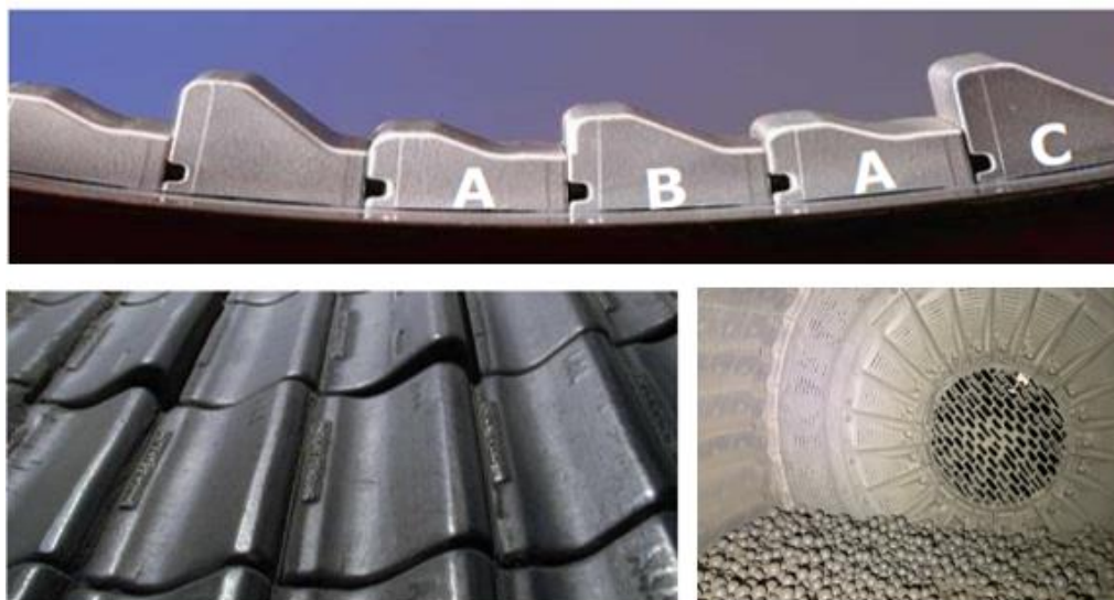
Figura 13 – Componentes internos do moinho.
