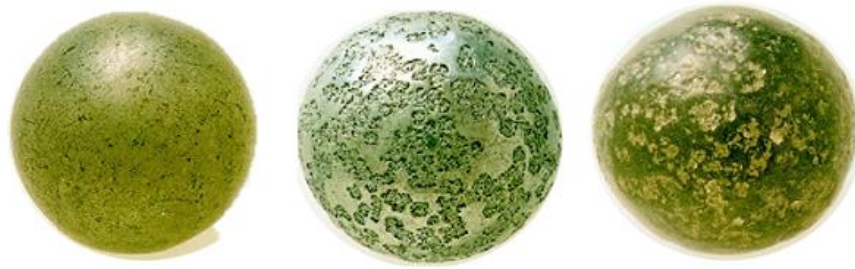
Figura 6 – Desgaste de corpos moedores.
