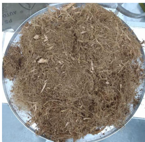
Figura 11 - Cascas de coco verde (100%CC) após processo de moagem em uma forrageira.
