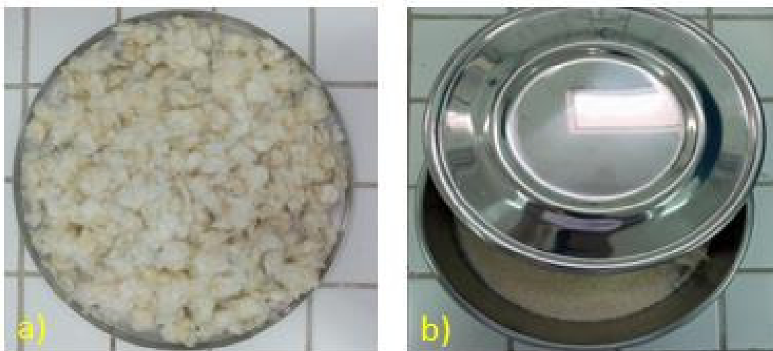
Figura 12 – Amostras das escamas de peixes (100%EP) após os processos de: a) secagem e b) das etapas de moagem e peneiramento.
