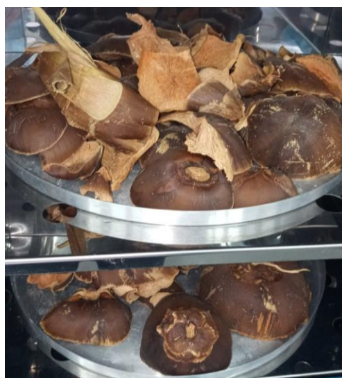
Figura 10 – Processo de secagem das cascas de coco verde em uma estufa por 48 horas a 60 °C.
