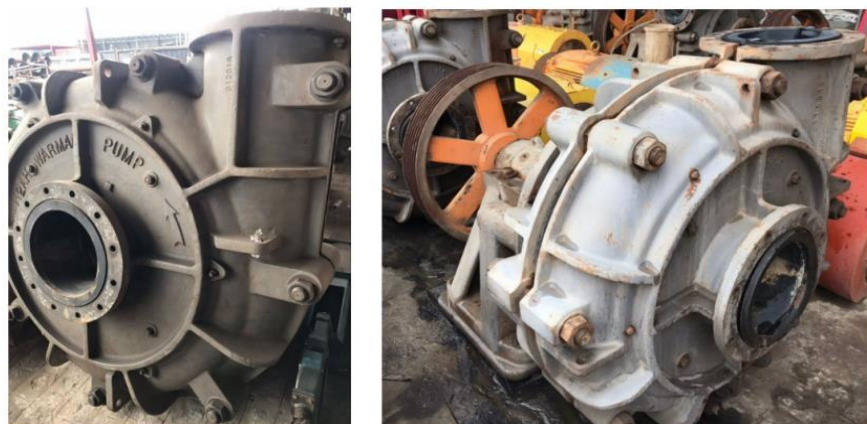
Figura 6 – Imagens ilustrativas do modelo das bombas Warman (Weir) .
