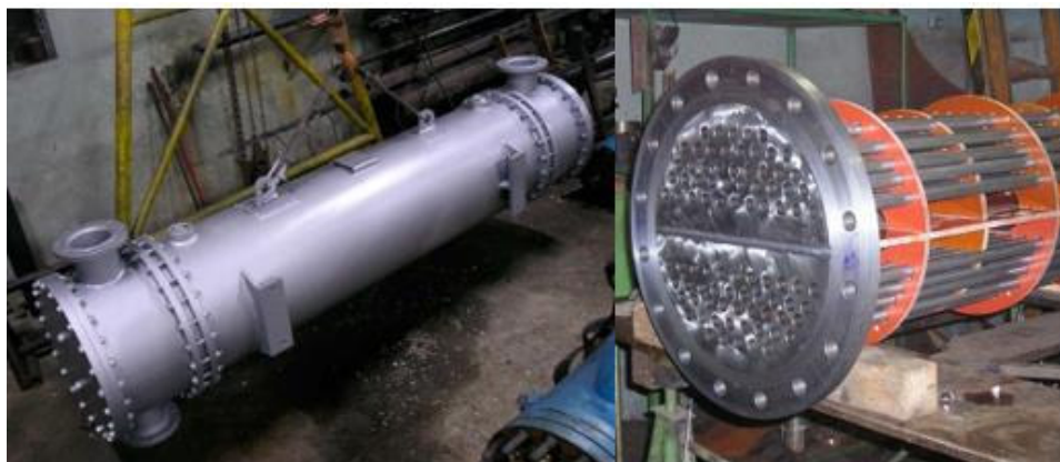
Figura 15: Vista explodida de trocador de calor do tipo casca-tubos Fonte: Adaptado de Fiorillo e Martins (2010).
