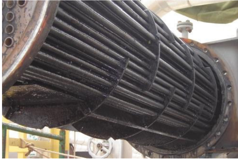
Figura 22: Feixe tubular de um trocador de calor industrial Fonte: Adaptado de Fiorillo e Martins (2010).
