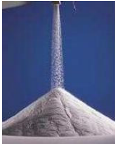
Figura 1: Grãos de Alumina em uma granulometria muito fina cerca de 0,3 microns. Fonte: Adaptado de Rocha (2018).
