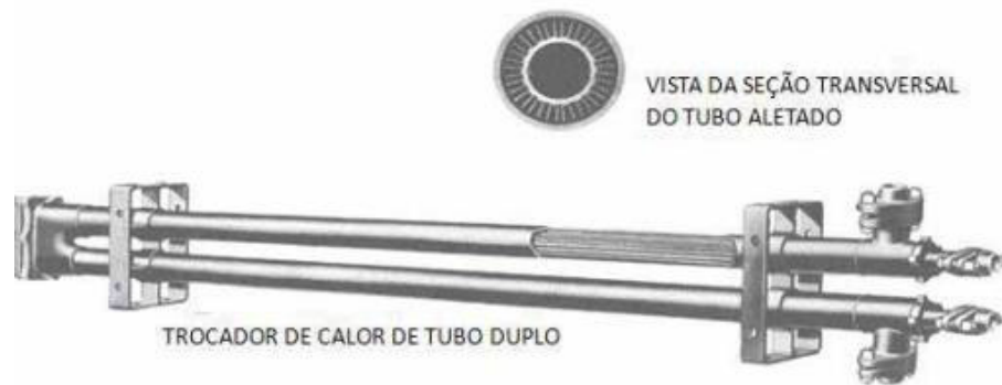
Figura 7: Exemplo de um trocador de calor de tubo duplo. Fonte: Adaptado de Kakaç (2002).
