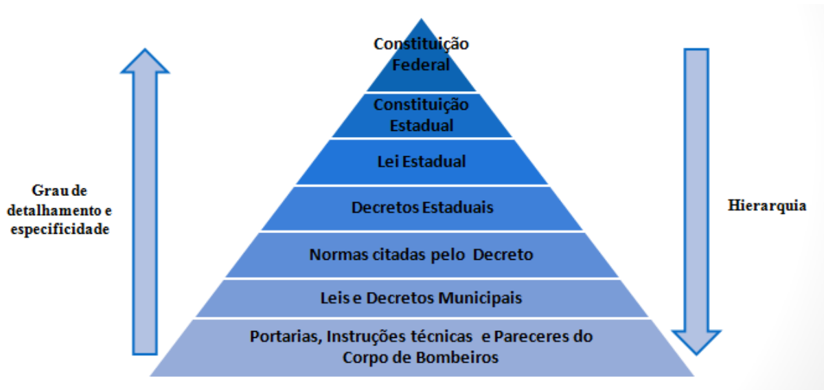
Figura 2.6 - Hierarquia e Grau de detalhamento e especificidade de regras para Projetos de Prevenção de Combate a incêndio
