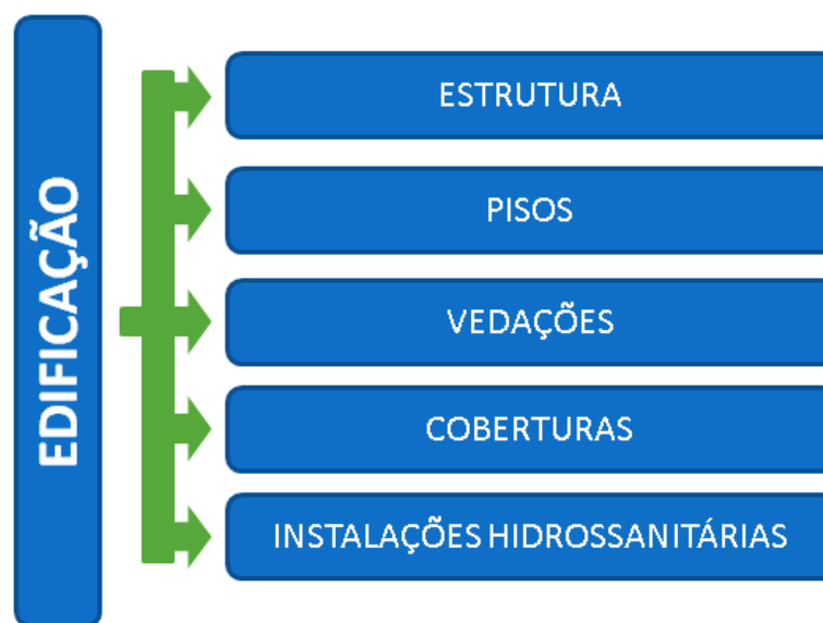
Figura 2.5 - Sistemas de uma edificação
