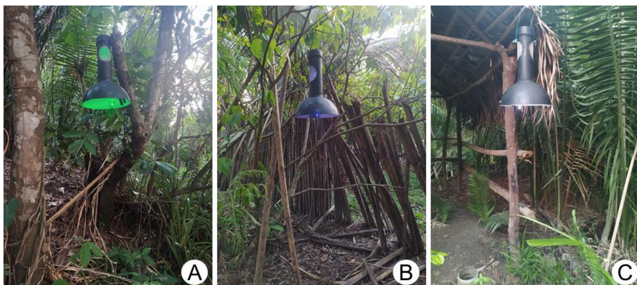
Figura 2 - Armadilhas Silva equipadas com LEDs. A : verde 15.000 mcd; B : azul 15.000 mcd; C : branco 18.000 mcd, utilizadas para captura de anofelinos no município de Vargem Grande - MA. Fonte: Sousa (2022).
