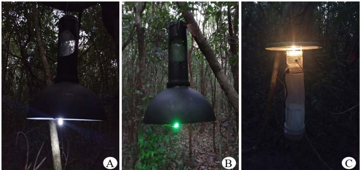
Figura 2 - Armadilhas Silva. A: LED branco (18,000mCD); B: verde (15,000mCD); C: armadilha do tipo CDC como controle (4watt, 6,3V, CM-47).
