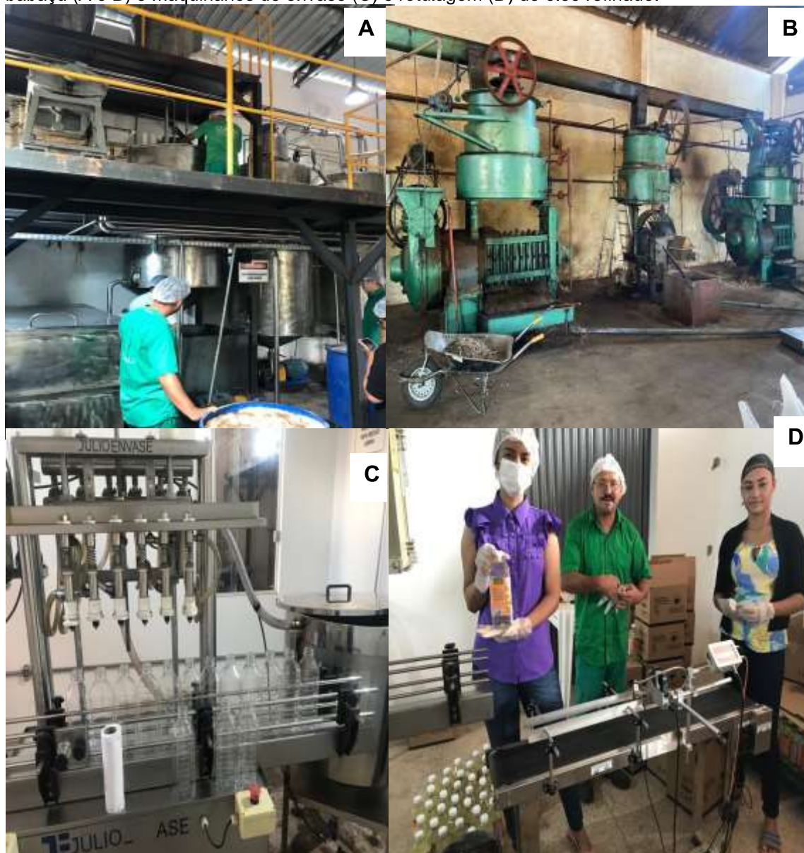
Figura 5: Planta industrial da COPPALJ na qual é realizado o processamento das amêndoas do babaçu (A e B) e maquinários de envase (C) e rotulagem (D) do óleo refinado.
