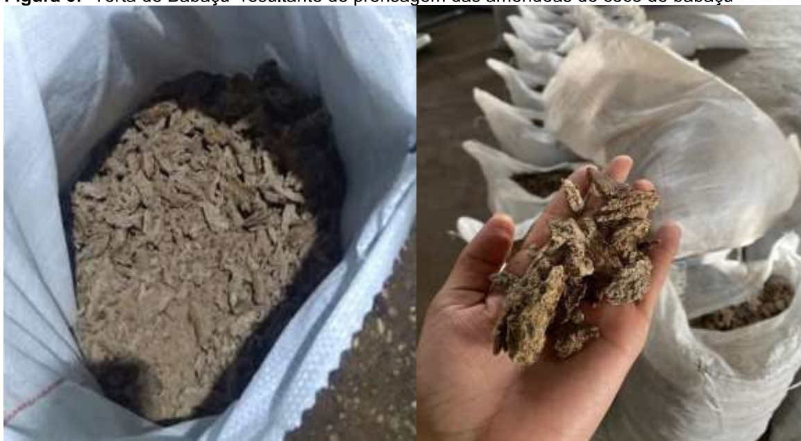
Figura 6: “Torta de Babaçu” resultante de prensagem das amêndoas do coco de babaçu
