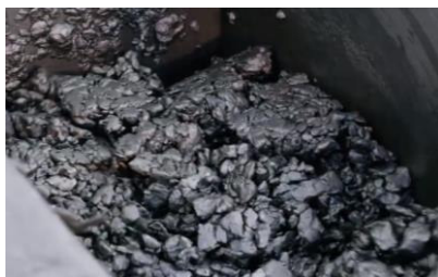
Fig. 33: Mistura de água, grafite e argila na fábrica Faber Castell:
