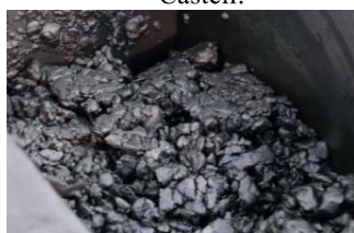
Fig. 33: Mistura de água, grafite e argila na fábrica Faber Castell:
