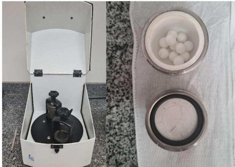
Figura 3. À esquerda, o moinho utilizado. À direita, visão superior do jarro de moagem (com 11 esferas de zircônia), ao lado da sua tampa.
