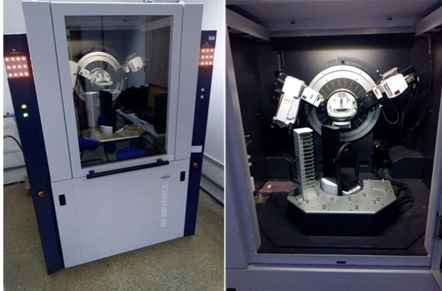
Figura 4. Difratorômetro D8 Advance (Bruker) da CeMatBio da UFMA.
