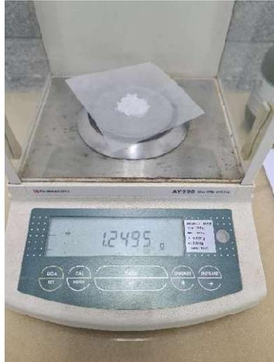
Figura 2. Balança SHYMAZU AY220 usada na pesagem dos reagentes.
