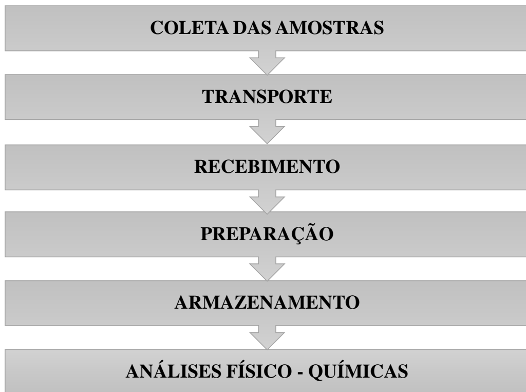
Figura 8: Fluxograma das etapas de coleta de amostras até as etapas de análises
