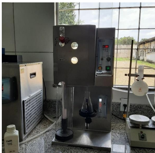
Figura 7: Aparelho Analisador de Amônia para Determinação de Nitrogênio Total
