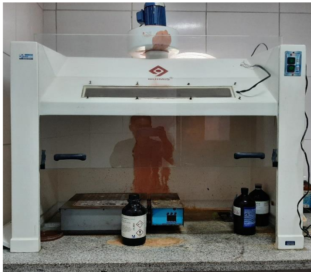
Figura 6: Capela de Exaustão de Gases
