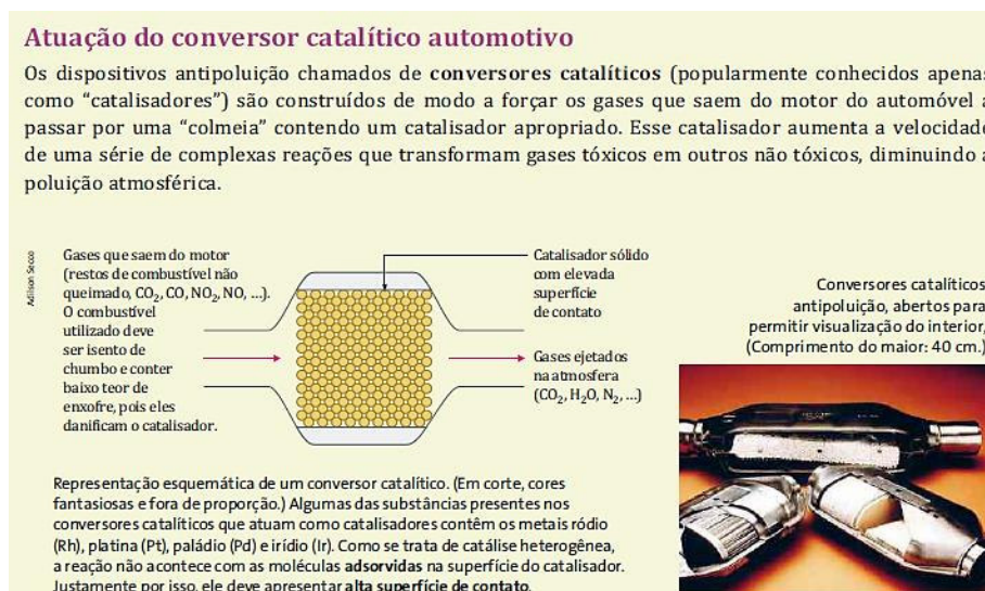
Figura 11 - Atuação do conversor catalítico automotivo.
