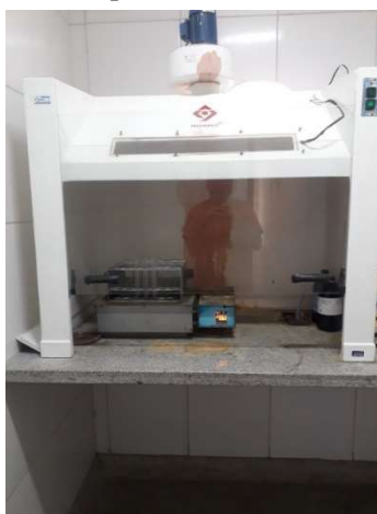
Figura 8 - Capela de Exaustão de Gases.
