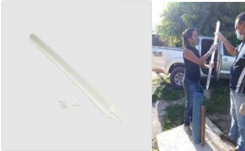
Figura 10: Foto ilustrativa de um Bailer (à esquerda) e Coleta no povoado Melancia (à direita)
