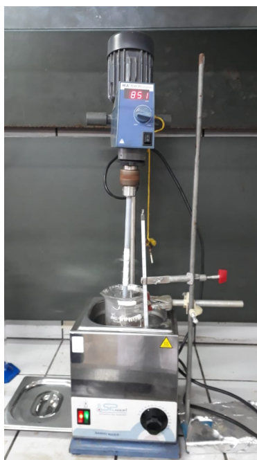
Figura 14: Estrutura usada no tratamento da fibra com peróxido de hidrogênio.
