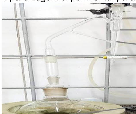
Figura 6 – Aparelhagem experimental para hidrodestilação
