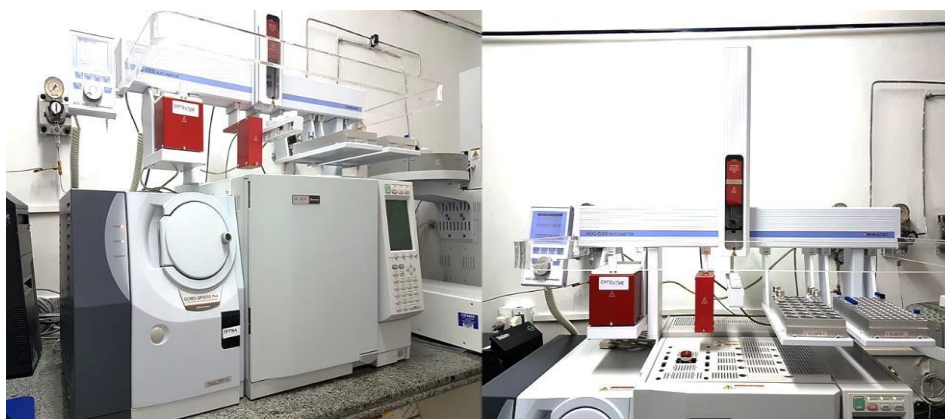
Figura 7 - Cromatógrafo a gás acoplado a espectrômetro de massas do Núcleo de Combustíveis, Catálise e Ambiental (NCCA)UFMA
