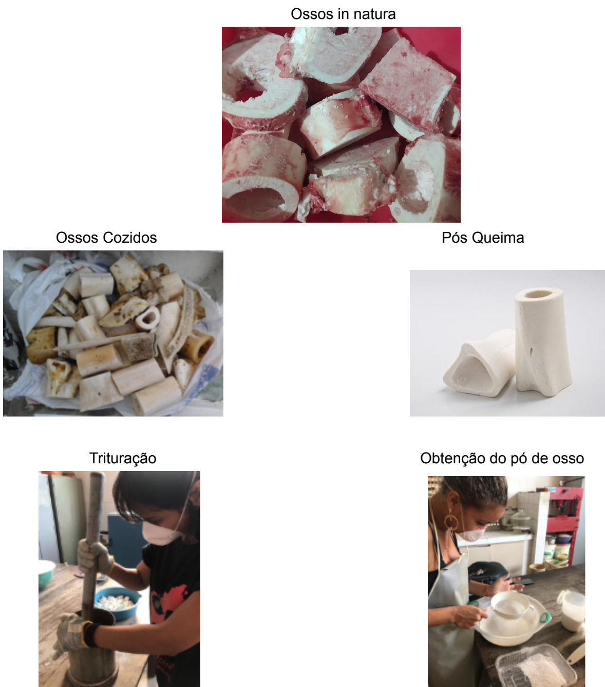
Figura 2 - Processo-Produção do Pó de Osso
