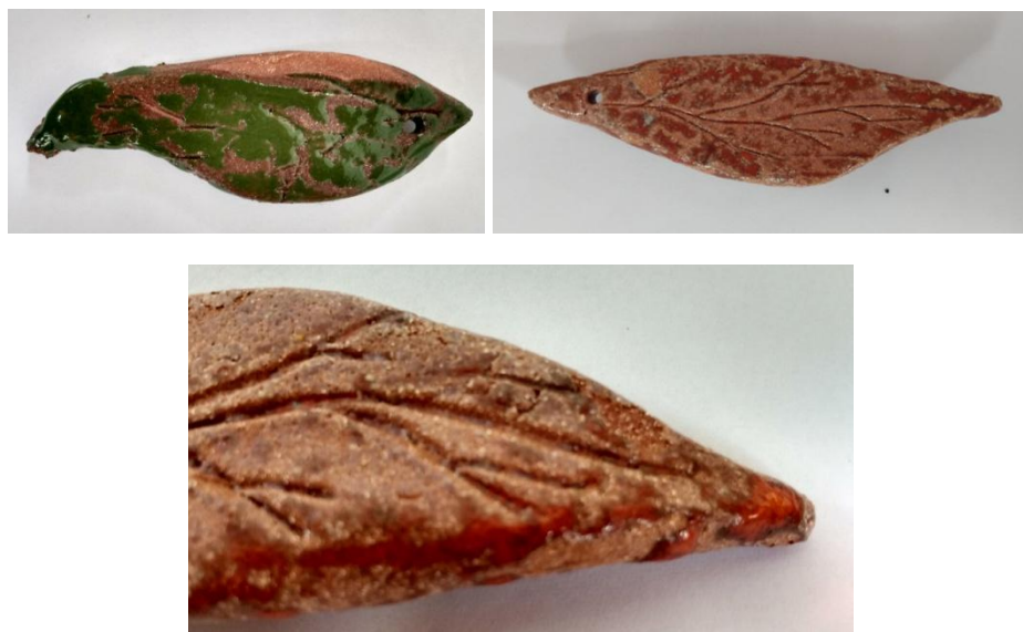
Figura 25: Folhas que não reagiram adequadamente à vitrificação
