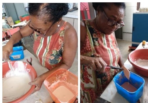
Figura 17: Técnica de pintura por imersão
