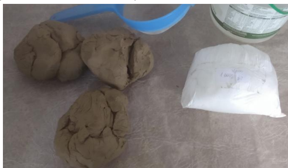
Figura 10: argila e pó de osso bovino em quantidade ideal
