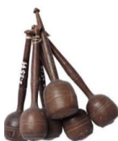
Bilro de madeira sucupira, numa só peça, feita em torno. Cabeça, canela e cabo torneados e bem alisados, com linhas horizontais circulando o cabo e a canela. Peça executada em Pilar – Alagoas. Oferecida à D. Luisa Ramos - nov. 1945.
