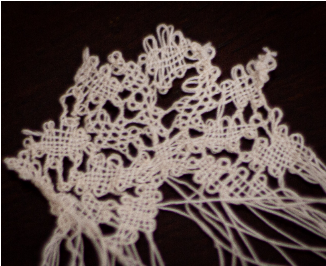
Imagem 134: Teste de confecção da renda em linha mercer crochet, núm.60 – a superfície gerada
