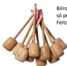
Bilro de madeira de uma só peça. Cabeça e canela bem torneados e lisos. Peça feita à máquina, em Alagoas.
