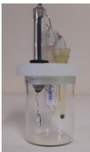
Figura 2: Célula eletroquímica e eletrodos utilizados durante o estudo, da esquerda para direita: eletrodo auxiliar, eletrodo de ouro e eletrodo de referência.
