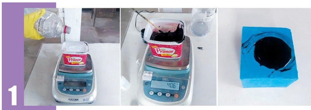
Figura 71 - Passo 1: Preparo da resina cristal.
