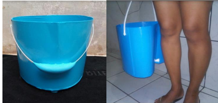
Figura 6 - Mock-up de um balde feito em papelão, utilizado em testes de usabilidade.
