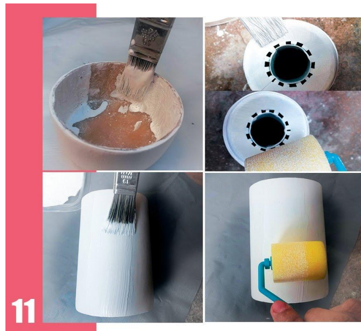
Figura 62 - Passo 11: Passar primer nos modelos.
