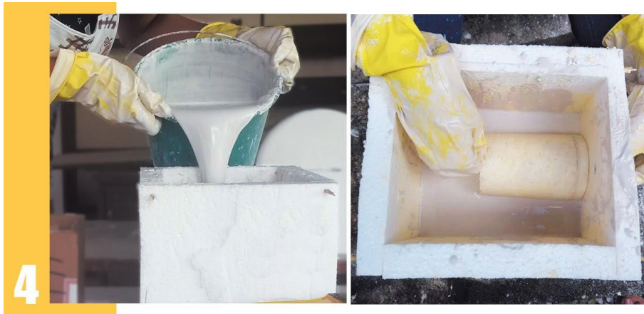
Figura 48 - Passo 4: Confeção da primeira metade do molde.
