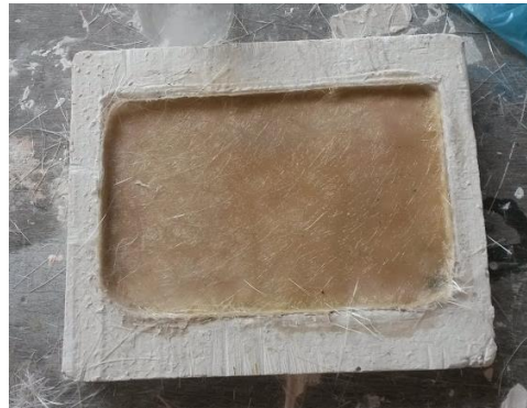
Figura 22 - Fibra de vidro laminada com resina sob um molde de gesso.
