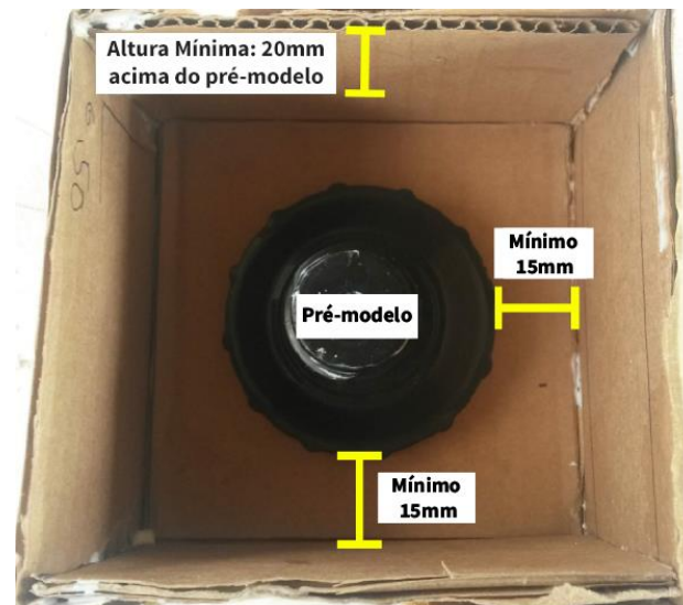
Figura 66 - Dimensões da caixa para molde de borracha de silicone.
