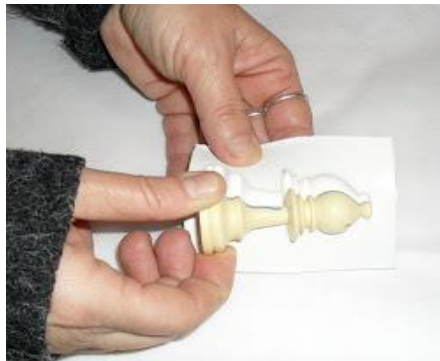
Figura 15 - Molde aberto feito de silicone.
