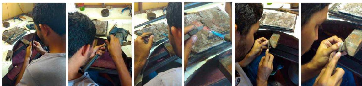
Figura 76 - Etapa de soldagem e lixamento
