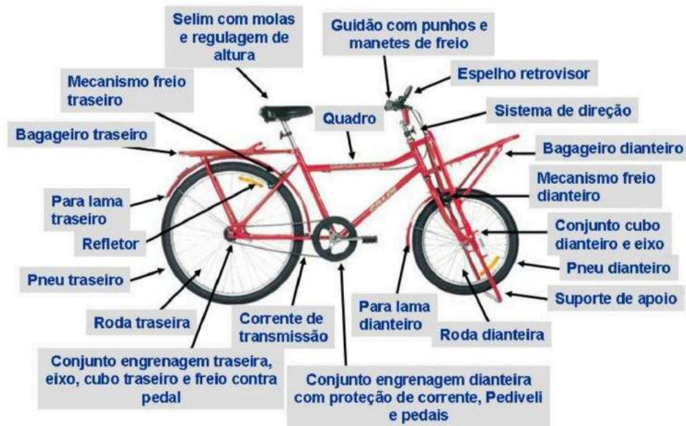
Figura 14 - Exemplo de análise estrutural.
