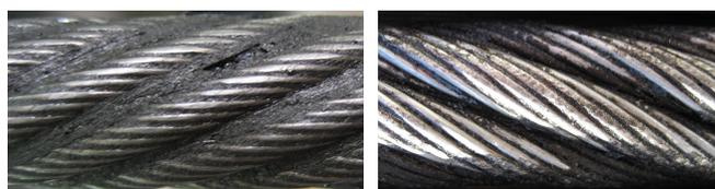
Figura 20 - Torção à esquerda e à direita respectivamente
