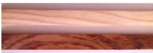
Figura 09 - Diferença de coloração entre amostra não termorreificada e após tratamento
