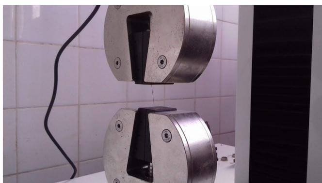
Figura 23 - Teste de tração nas amostras de cordas de violão
