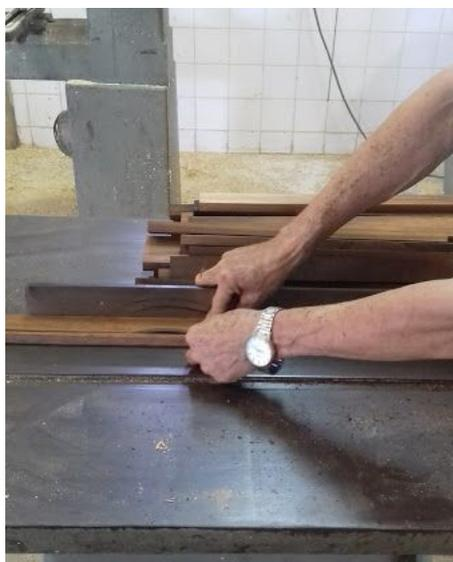
Figura 30 - Cortando amostras na serra circular
