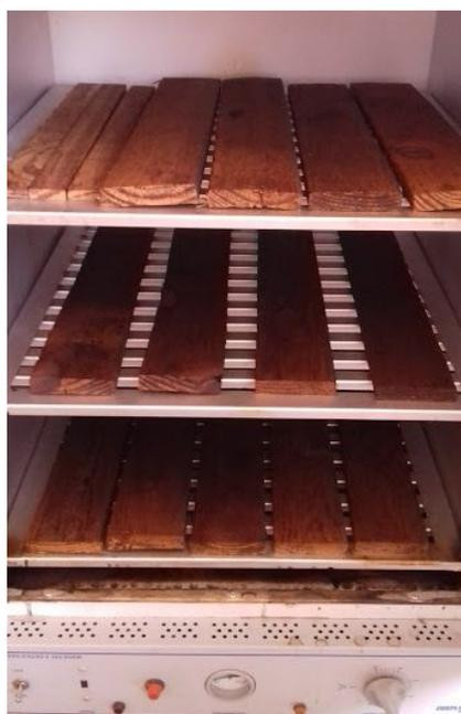
Figura 07 - Amostras de palete no forno após termorretificação
