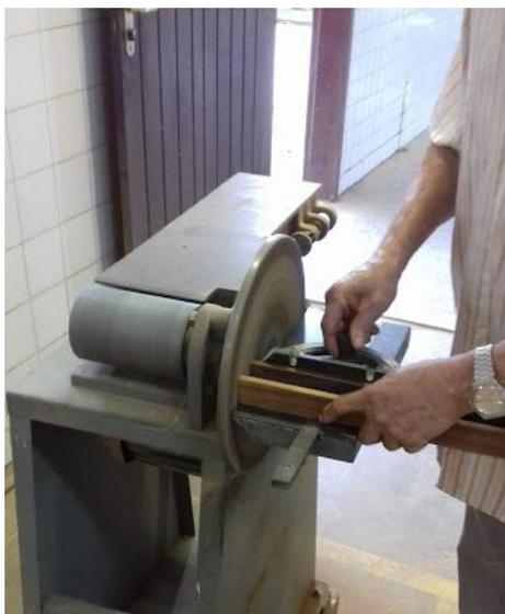
Figura 34 - Peças coladas sendo lixadas para eliminar desníveis
