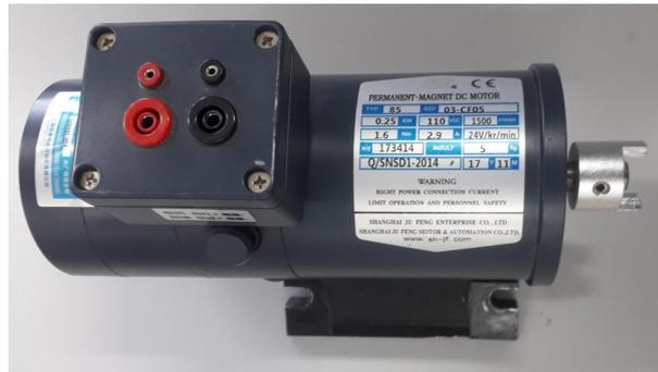
Figura 23 – Motor CC de 250W. Imagem executada pelo autor.
