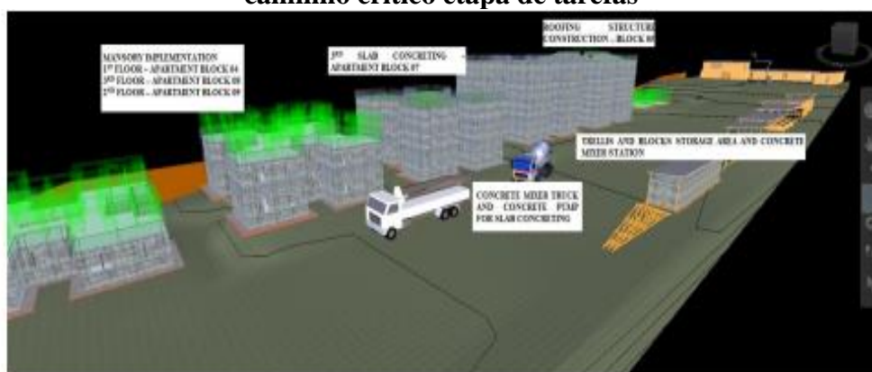
Figura 5 - Imagem do Software Navisworks mostrando layout do canteiro de obras no caminho crítico etapa de tarefas
