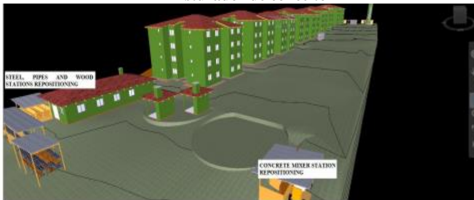
Figura 8-Imagem do Software Navisworks mostrando a configuração do layout do canteiro de obras com os centros de materiais e o reposicionamento da estação do misturador de concreto
