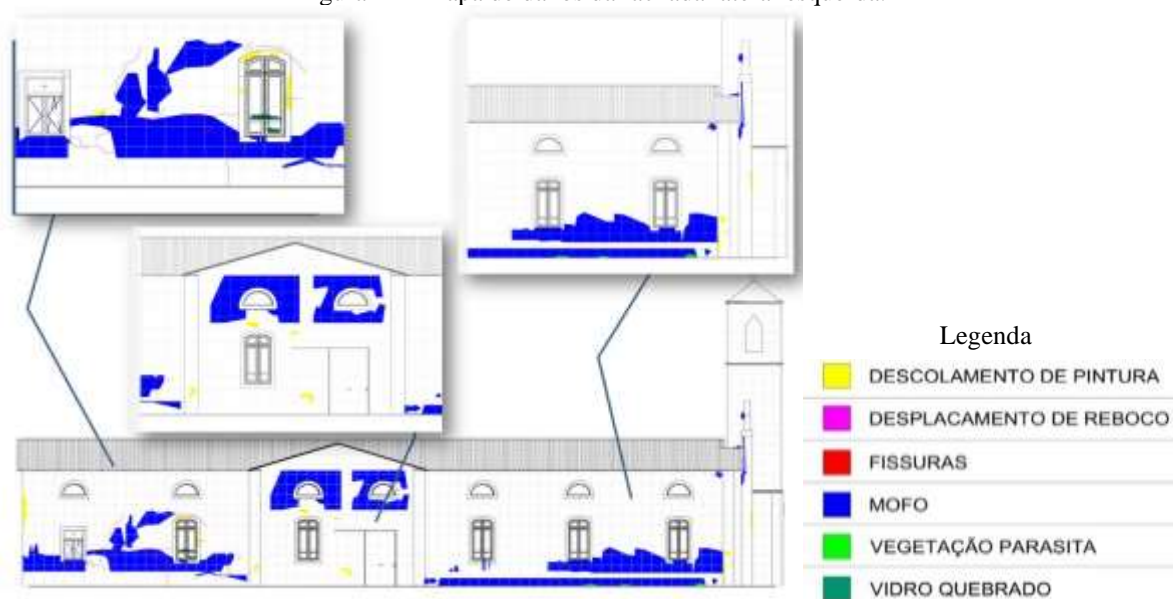
Figura 21 - Mapa de danos da fachada lateral esquerda.
