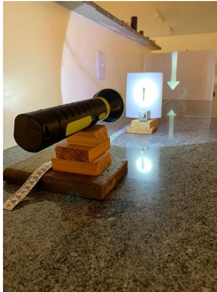
Figura 33 - Montagem do experimento de Bessel (Autor, 2021)
