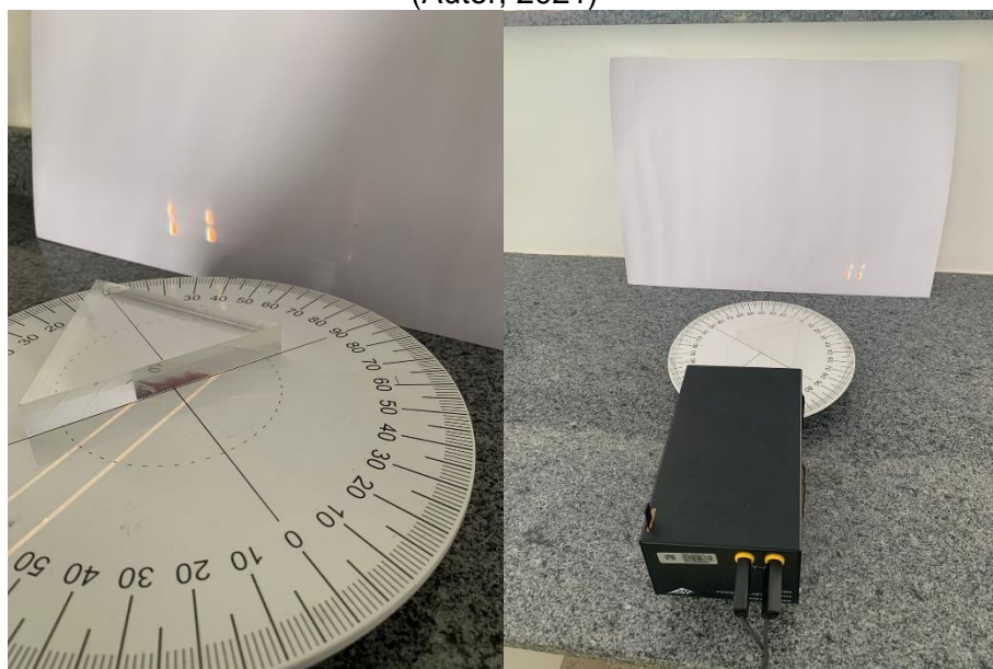
Figura 41 - Esquema montagem do experimento da dispersão no laboratório (Autor, 2021)
