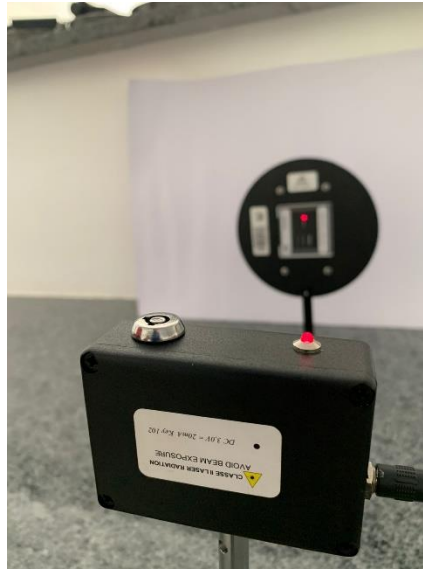
Figura 48 - Experimento da fenda dupla montado no laboratório (Autor, 2021)
