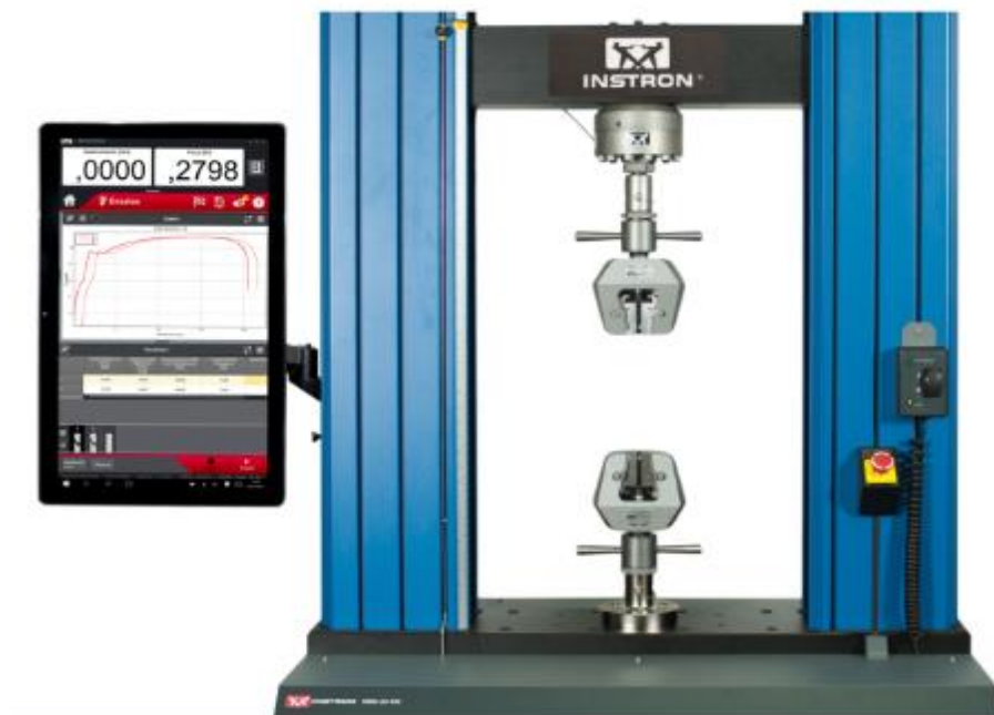
Figura 11: Máquina universal de ensaios mecânicos Instron M10-16927.
