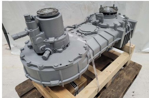
Figura 15 - Transmissão de um guindaste Liebherr
