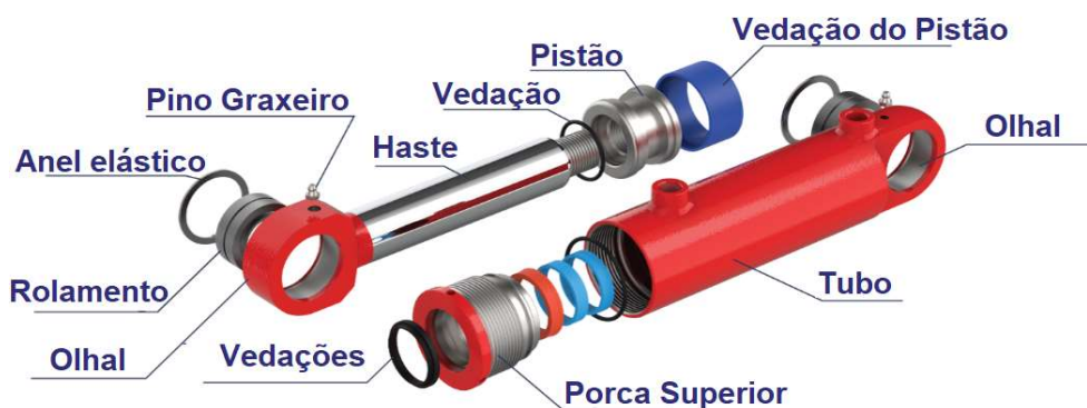
Figura 14 - Visão explodida de um cilindro hidráulico
