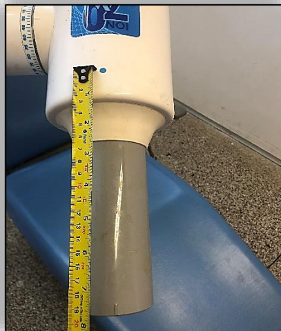
Figura 3- Medição do comprimento do localizador
