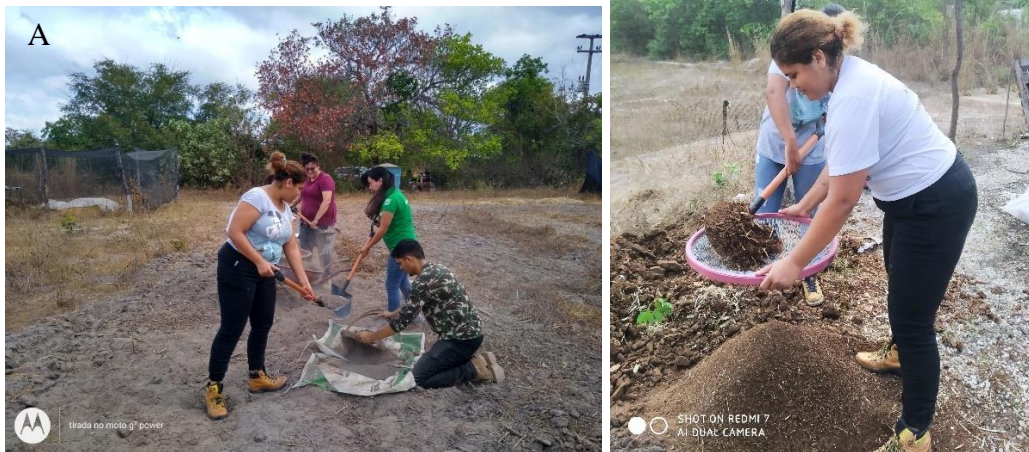
Figura 5. Coleta do solo (Latosolo Amarelo distrófico) na área experimental do Centro de Ciências de Chapadinha, peneiramento para homogeneização do solo (A) e da fitomassa decomposta de babaçu (B).
