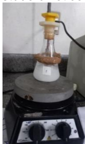
Figura 7: Sistema para estudo cinético de anilina em Talco USP .
