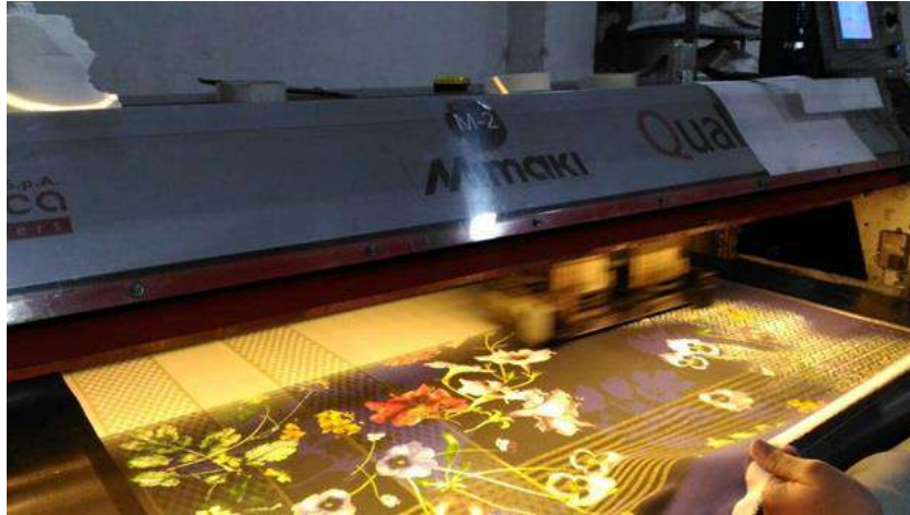
Figura 33 - Estampa sendo aplicada no tecido por meio de impressão digital
