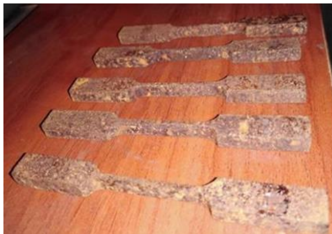
Figura 7 - Corrosão do aço SAE 1045
