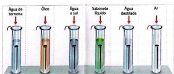
» Pregos de ferro em diferentes meios de armazenagem.
