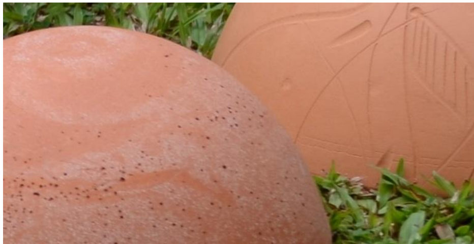
Figura 23 - Produto com acabamento natural em PO (com pontos brancos) e produto sem PO.
