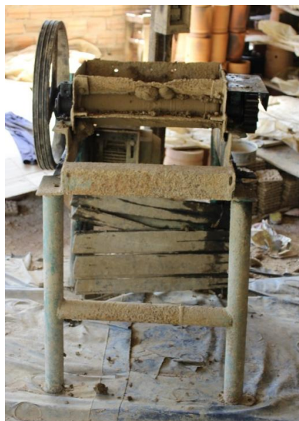
Figura 08 - Limpeza da argila em Rosário.
