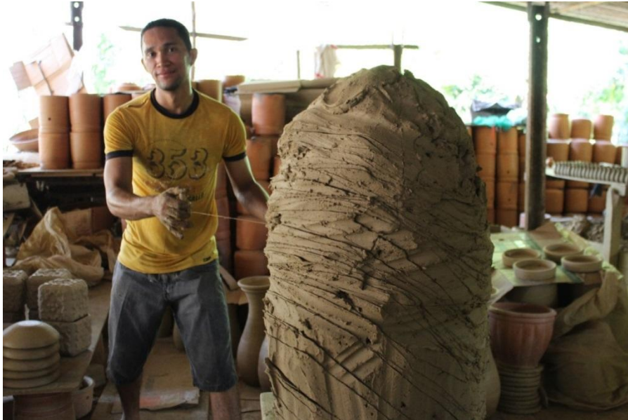
Figura 09 - Limpeza da argila utilizando fio de nylon
