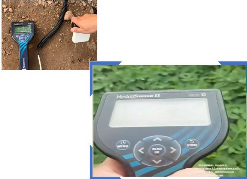
Figura 3. Avaliação da umidade do solo por meio da TDR
