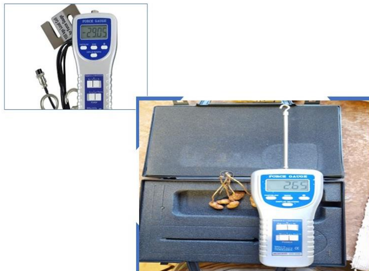
Figura 5. Avaliação da resistência do ginóforo ao rompimento por meio de um dinamômetro digital
