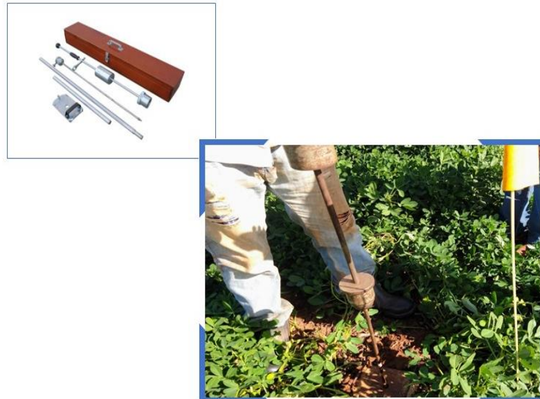
Figura 4. Avaliação da resistência mecânica do solo à penetração na camada de 0 - 20 cm
