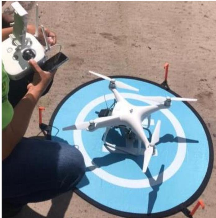
**Figura 11:** Manuseio e calibração do Phantom 4 Pro.
