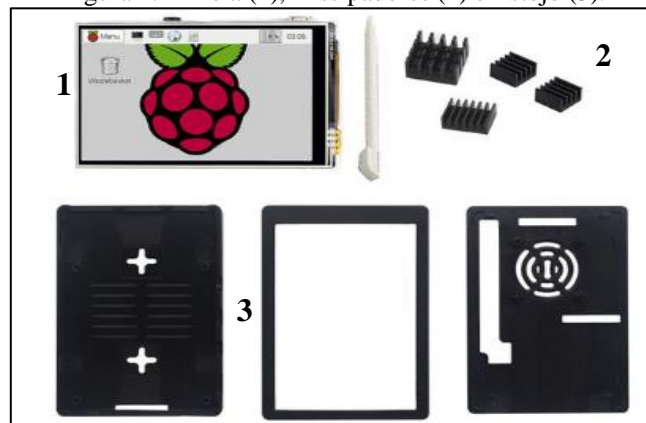
Figura 4.4 - Tela (1), Dissipadores (2) e Estojo (3).
