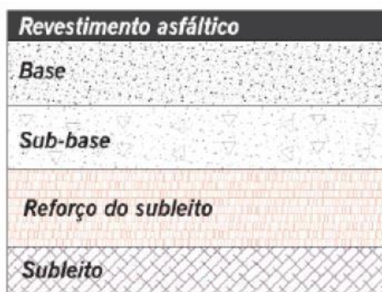
Figura 3 - Camadas de um pavimento flexível.
