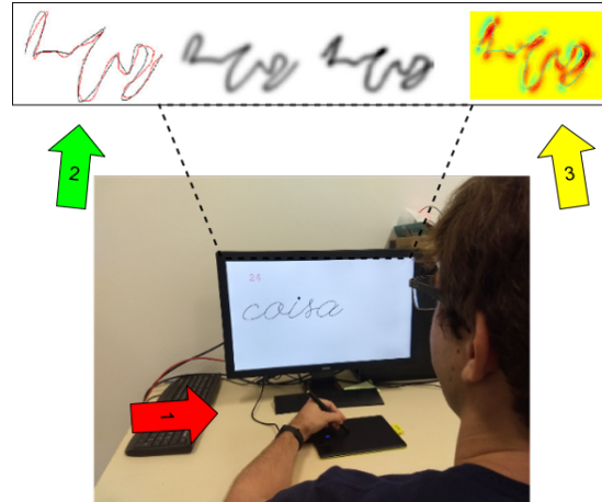
Figura 5 – Representação de uma trial no software da tarefa de decalque. Como indicado pela seta vermelha 1, o participante utiliza a mesa digitalizadora com a mão esquerda para tentar desenhar a palavra que aparece na tela. A palavra desenhada e a palavra modelo, indicados pela seta 2 verde, são borradas com um kernel gaussiano para a extração da métrica de cada trial (seta 3 amarela).
