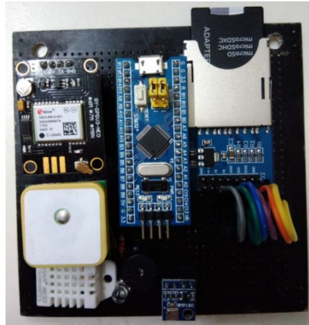
Figura 4 - Computador de bordo do protótipo montado em uma placa de circuito impresso
