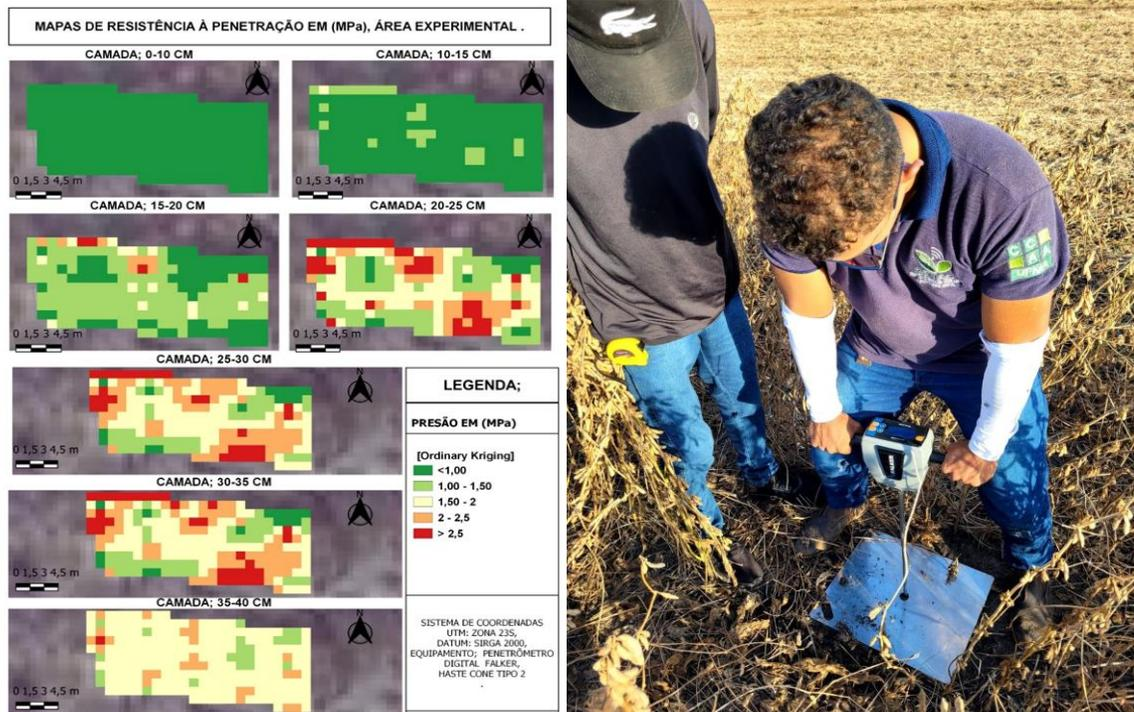
**Figura 6:** À esquerda o mapa de resistência à penetração para avaliar o grau e compactação do solo conforme dados do penetrômetro em lavoura plantada com soja (*Glycine max*), de uma área experimental na fazenda Europa localizada no Leste maranhense município de Buriti, avaliação realizada pelo grupo de pesquisa da Universidade Federal do Maranhão e Field Crops, e a direita utilização do penetrômetro para levantamento de dados de resistência
