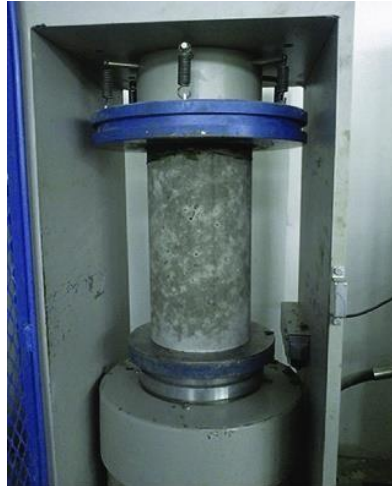
Figura 7: Ensaio de compressão de concreto
