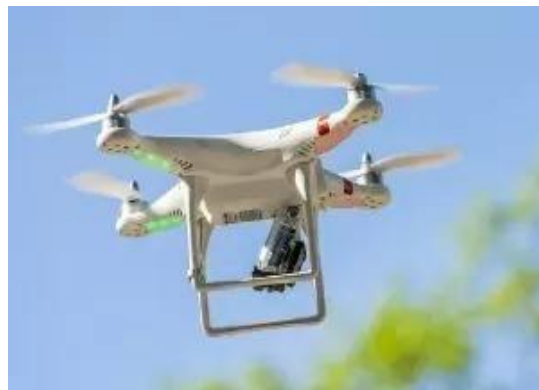
Figura 16: Drone para filmagem aérea
