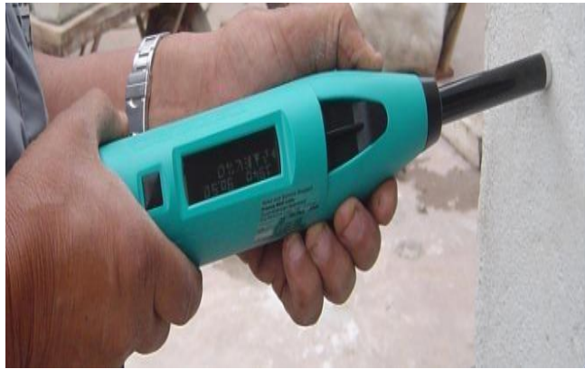
Figura 19: Ensaio de esclerometria
