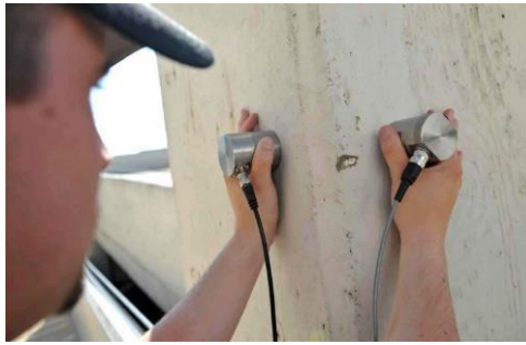
Figura 17: Ensaio de Ultrassom
