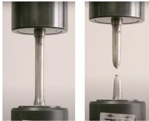
Figura 8: Ensaio de tração de aço
