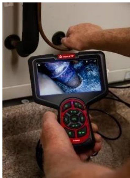
Figura 15: Boroscópio em utilização para verificar o interior de uma tubulação
