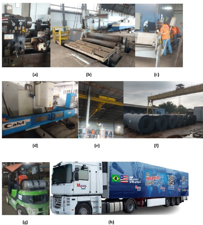
Figura 18 – Equipamento fixos e movimentação de carga: (a) Torno, (b) Calandra, (c) Guilhotina, (d) Máquina de Plasma (e) Ponte Rolante, (f) Pórtico Rolante, (g) Empilhadeira, (h) FAMTHE-fábrica móvel de tubos helicoidais.
