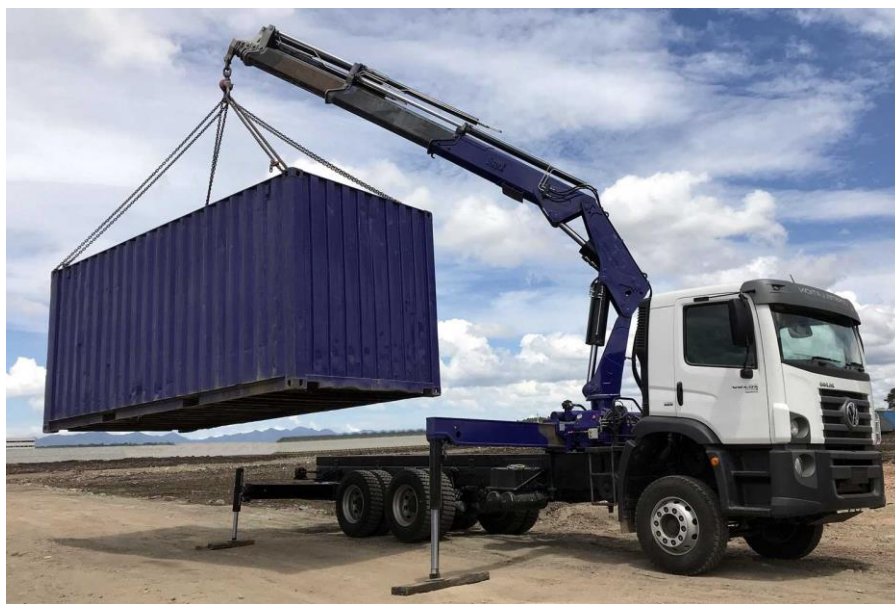
Figura 5 - Caminhão Munck utilizado para transporte e alocação de contêineres
